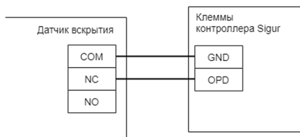
Подключение датчика вскрытия корпуса к контроллеру.
